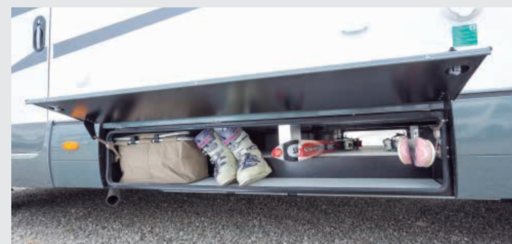
7 AL-KO Chassis mit durchgängig doppelten Boden.
